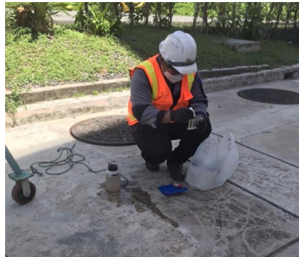
รูปที่ 2.2-25 การเก็บตัวอย่างน้ำเพื่อทำการวิเคราะห์คุณภาพน้ำทิ้ง
